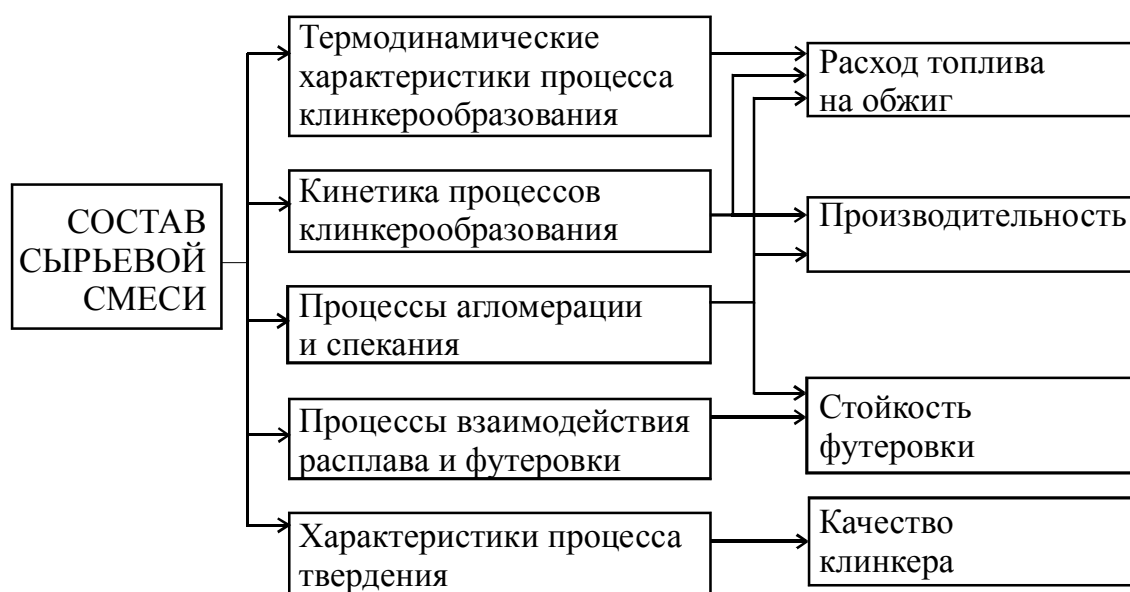
Рис. 10.2. Влияние состава сырьевой смеси на качество клинкера и процесс обжига
