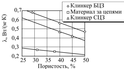
Рис. 4.3. Зависимость теплопроводности от суммарной пористости
