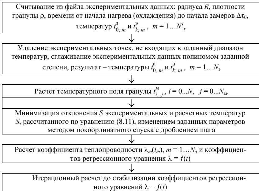
Рис. 3.9. Алгоритм расчета коэффициента теплопроводности
