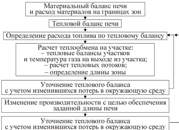
**Рис. 6.2. Итерационный расчет теплообмена в действующей печи**
