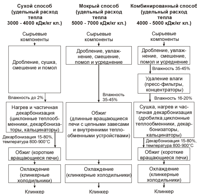
Рис. 1.1. Технологические схемы обжига клинкера
