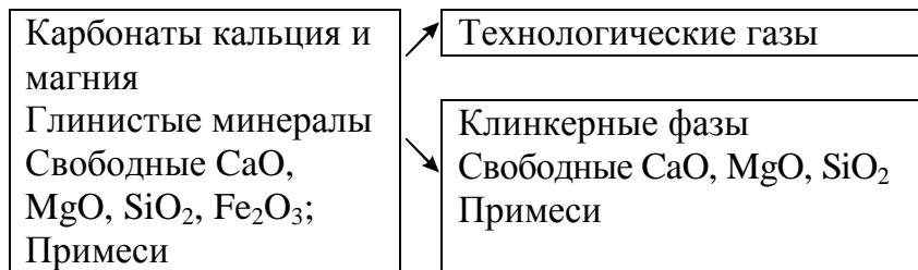
Рис. 7.5. Схема преобразования сырьевой смеси в клинкер
