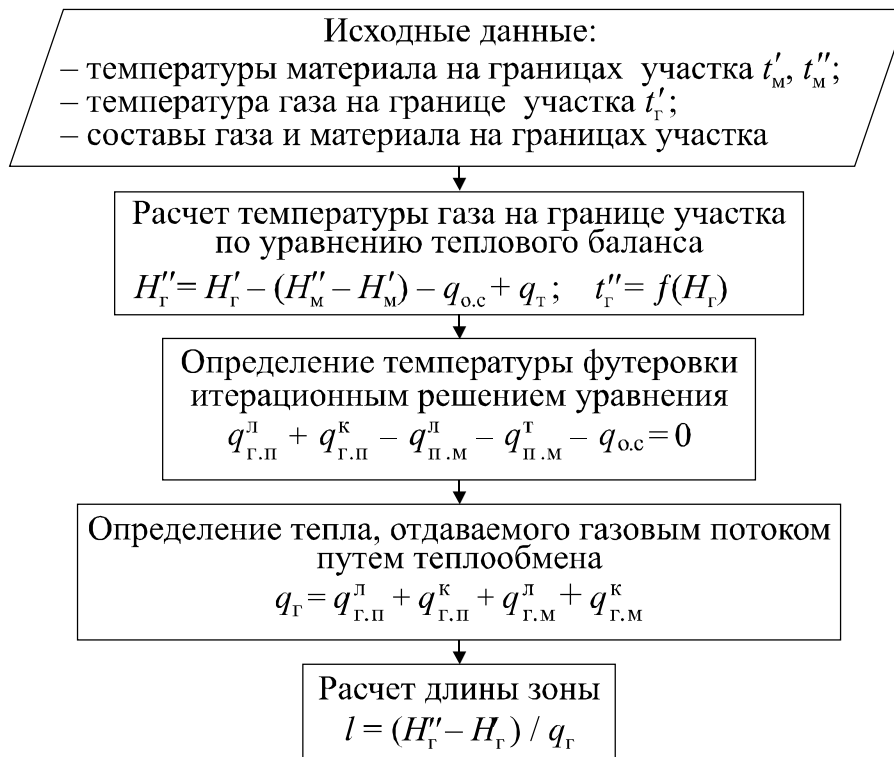
Рис. 4.7. Расчет теплообмена на участке печи
