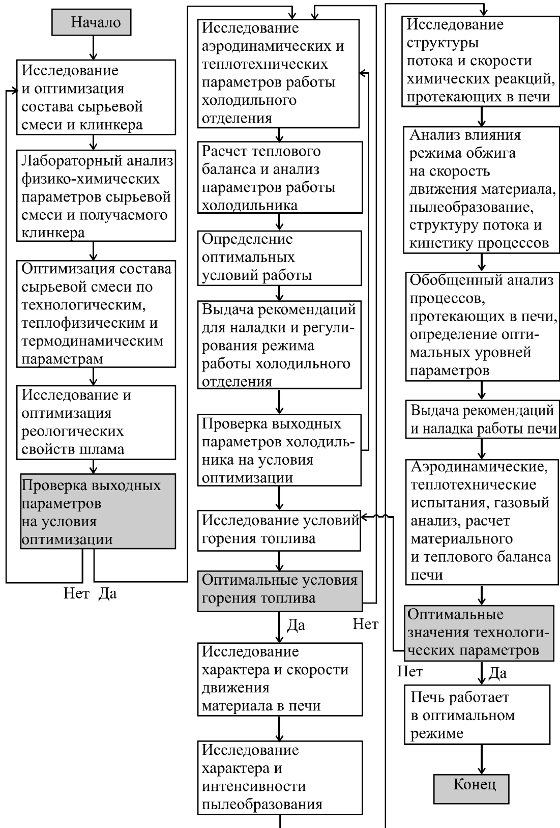
Рис. 11.4 Последовательность операций по интенсификации и оптимизации процесса обжига
