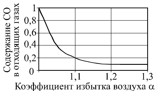
Рис. 3.20. Зависимость недожога от коэффициента избытка воздуха при сжигании газообразного топлива в цементных вращающихся печах [68]
