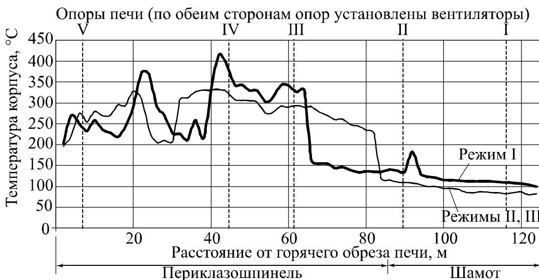
Рис. 3.6. Средняя температура корпуса печи № 8: замеры проводились через 2 м, потери теплоты составляют 13,84 МВт для режима I и 13,73 МВт для режимов II и III
