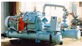
Рис. 14. Тепловой насос НКТ – 300 (моноблочная компоновка)
