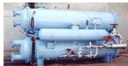
Рис. 15. Тепловой насос НТ – 1000 (раздельная компоновка)
