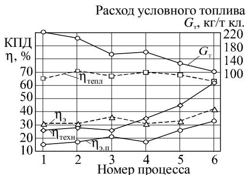
Рис. 25. Энергетическая эффективность процессов обжига клинкера
