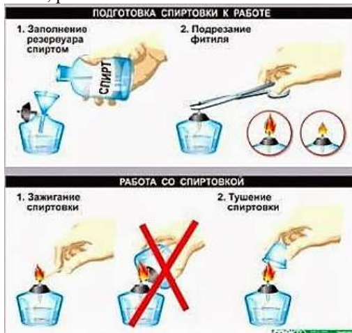
Рис.3.1. Правила безопасности при работе со спиртовкой
