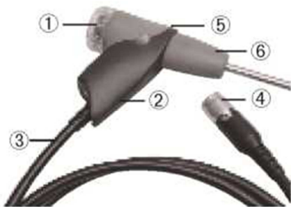
Рис.7. Зонд отбора проб газоанализатора TESTO 330-1:
