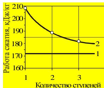
Рис. 14.1. Работа при многоступенчатом сжатии воздуха при  $\varepsilon = 9$ :
