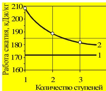
Рис. 14.1. Работа при многоступенчатом сжатии воздуха при  $\varepsilon = 9$ :
