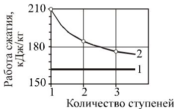
Рис. 1.9. Работа при многоступенчатом сжатии воздуха ( e = 9 ): 1 – изотермическое сжатие; 2 – политропное сжатие при n = 1,2
