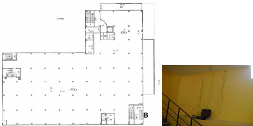
Рис. 2.7. Место замеров сопротивления теплопередаче ограждающей конструкции на первом этаже торгово-офисного здания
