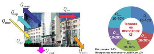
Рис. 1.1. Тепловой баланс здания
