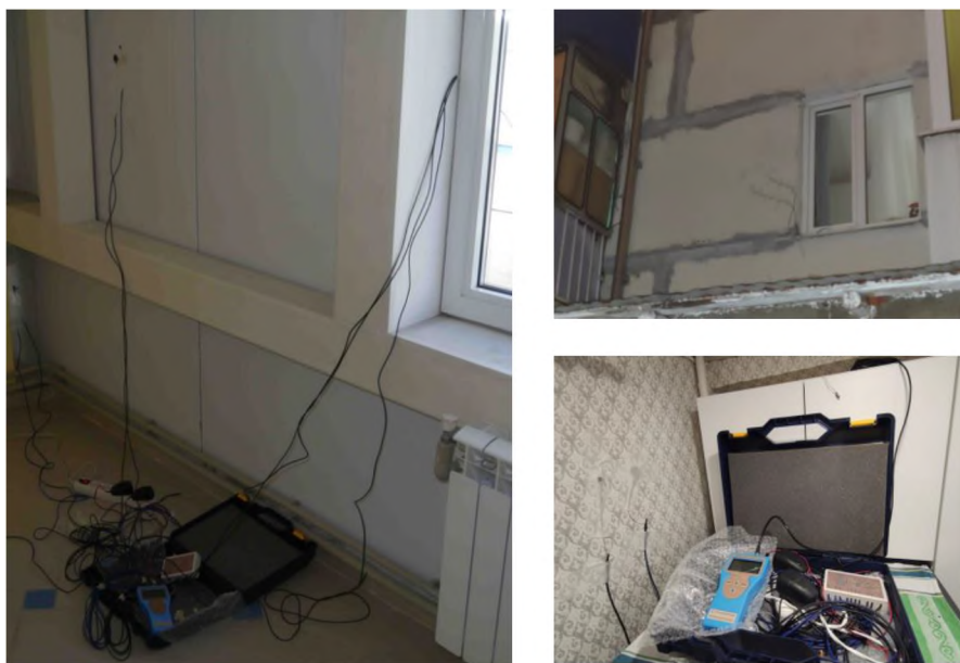
Рис. 1.18. Измерение сопротивления теплопередачи с использованием измеритель плотности тепловых потоков и температуры ИТП-МГ4.03/Х(1) «ПОТОК» (изготовитель ООО «СКБ Стройприбор», г. Челябинск)
